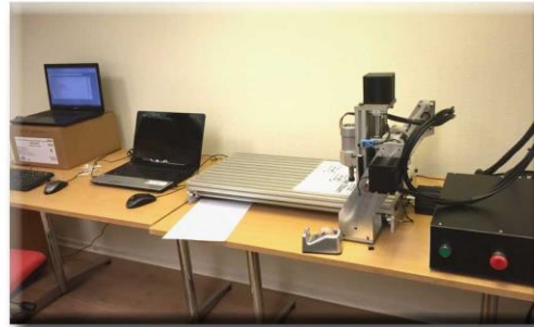
Med vår CNC fräs kan vi snabbt få fram prototyper som sedan leder till produktion.
